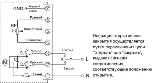
**Тип D: Позиционный переключатель с потенциометром и пассивным контактом**
